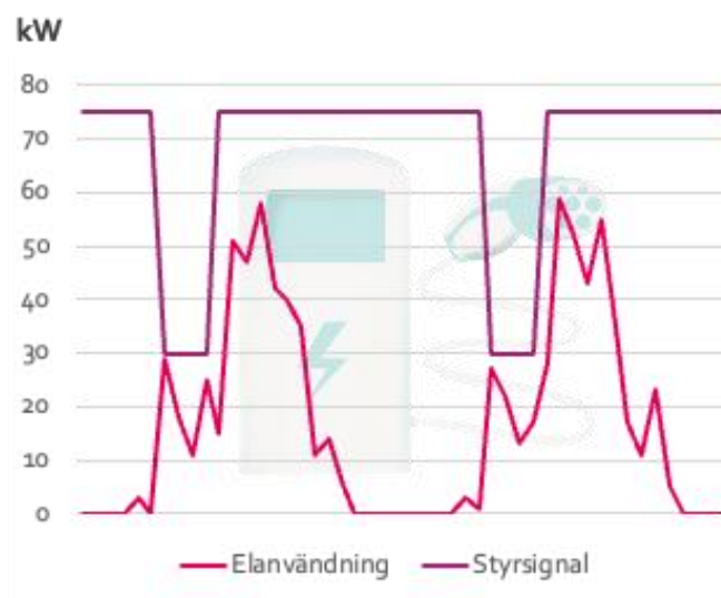
Figur 4. Exempel på ett garage med laddare som förhåller sig till en begränsad effekt under kritiska tidpunkter för lokalnätet.
